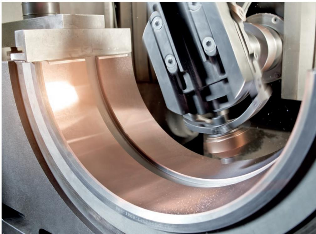
**Über 85 Jahre Erfahrung in der Kurbelwellenschleiferei hat unser Unternehmen auch zum Spezialisten in der Überarbeitung und Herstellung von Gleitlagern werden lassen. Alle gängigen Gleitlager werden individuell im Haus gefertigt.**
